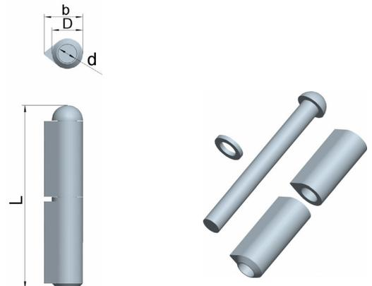
**Anschweißbandrollen aus gezogenem Profileisen mit rundem Kopf
